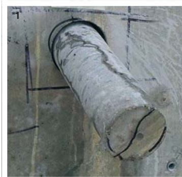
Foto 1) Campionature di valutazione con carotaggi dalla matrice in calcestruzzo delle strutture interrato sotto falda marina del Terminal 3 dell'aeroporto di Singapore Foto 2) Presenza di cristalli di differente forma e dimensione lungo una fessurazione: essi sigillano completamente la crepa (cristalli C-S-H, Silicato di Calcio Idrato) Foto 3) Ingrandimento "BEI" (backscattered electron image), mostra la crescita cristallina all'interno di una microfessurazione Foto 4) Particolare ulteriormente ingrandito della "BEI" mostra le tipologie di cristalli: sottili e oblunghi, fini ed aghiformi.
